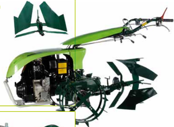
JEDNOBRAZDNI OKRETNI PLUG PJO 180° Dubina oranja: 20 cm
